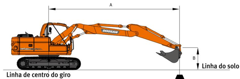
Pluma: 4.988mm(16'4") Brazo: 2.500mm(9'10") Cuchara: SAE 0,51m<sup>3</sup>(0,67yd<sup>3</sup>) Zapata: 700mm(2'4")
