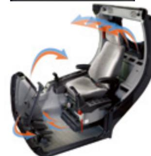
El aire acondicionado de alto rendimiento provee un caudal de aire que se ajusta y controla electrónicamente según las condiciones imperantes. Cinco modos de operación hacen que aun el operador más exigente pueda verse satisfecho.
