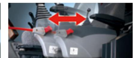
Confortable asiento deslizante de dos posiciones de regulación.
