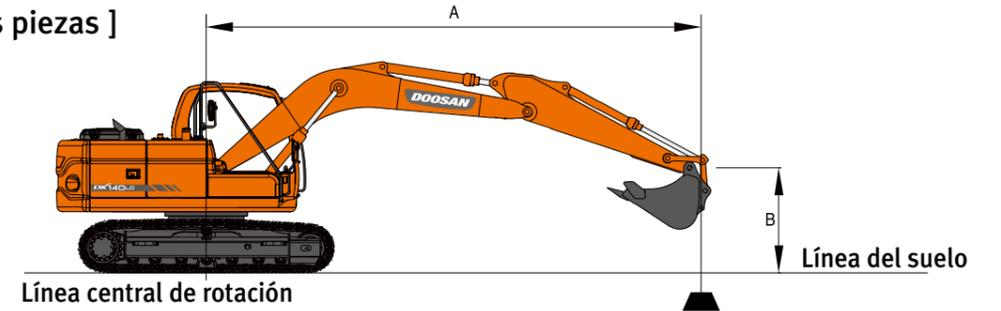
Pluma: 4.600mm(15'1") Brazo: 2.500mm(8'2") Cuchara: SAE 0,51m<sup>3</sup>(0,67yd<sup>3</sup>) Zapata: 600mm(2')
